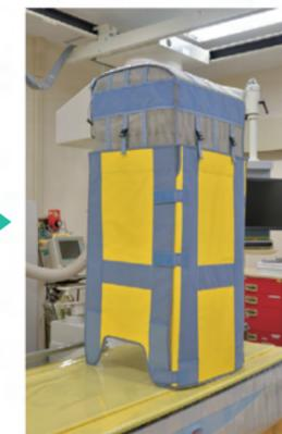
④ 両側面の遮へいシートをマジックテープで接着し完了
